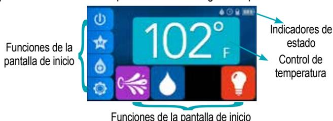
**NOTA:** el control remoto inalámbrico vuelve a la pantalla de inicio después de 45 segundos si no se utiliza ninguna otra pantalla.
